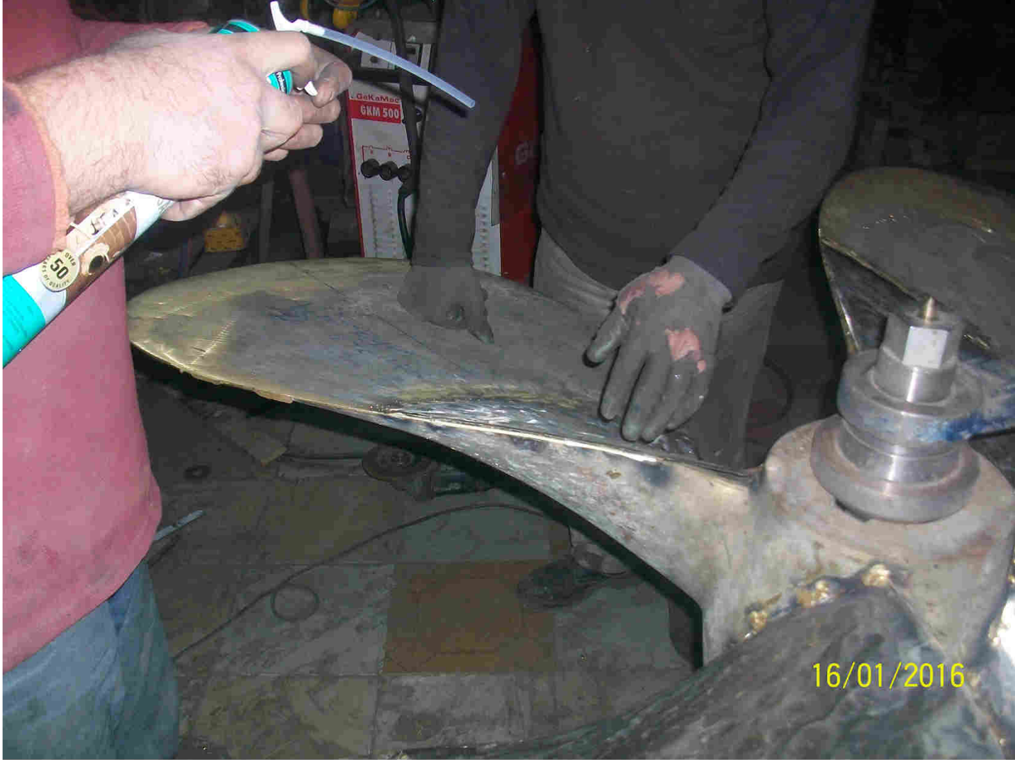
Suyun nufus etmesini önlemek üzere köpük doldurulması
