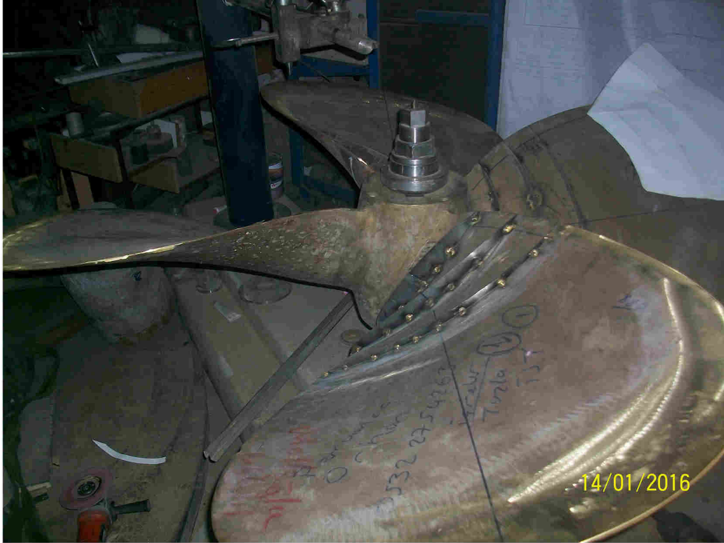
Kanat kesimlerinin kaynatılması
