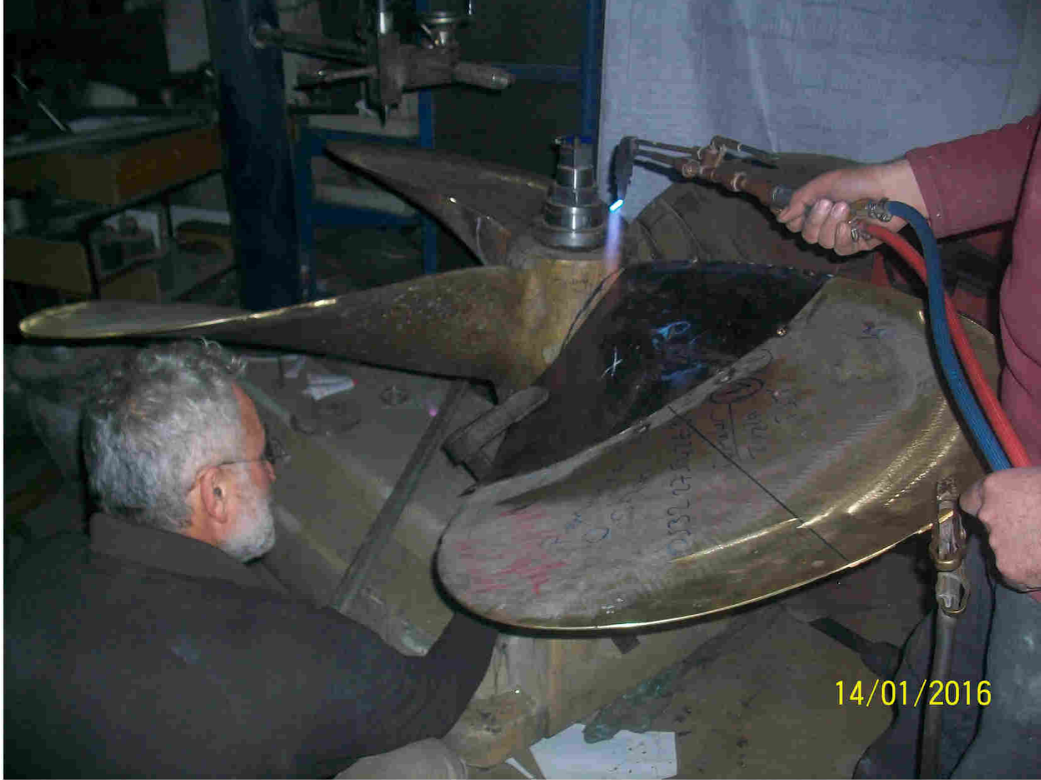
Krom kaplamanın alıştırılarak yerine kaynatılması
